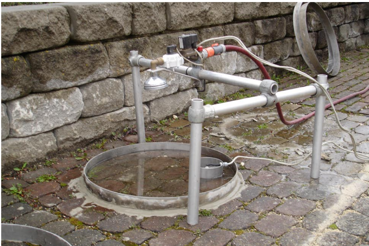
Bild 2: Infiltrationsgerät im Einsatz
